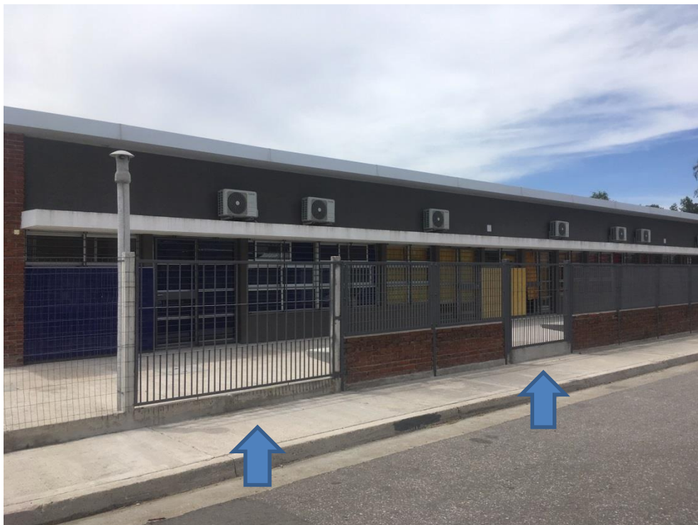
Tramos de tejido perimetral sustituidas por reja
